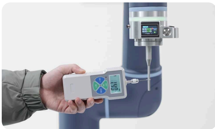
Легкие перемещения в режиме Free drive с настраиваемым усилием от 1.5 Н
