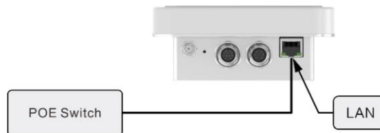
Рисунок 5. Схема подключение питания через адаптер PoE
