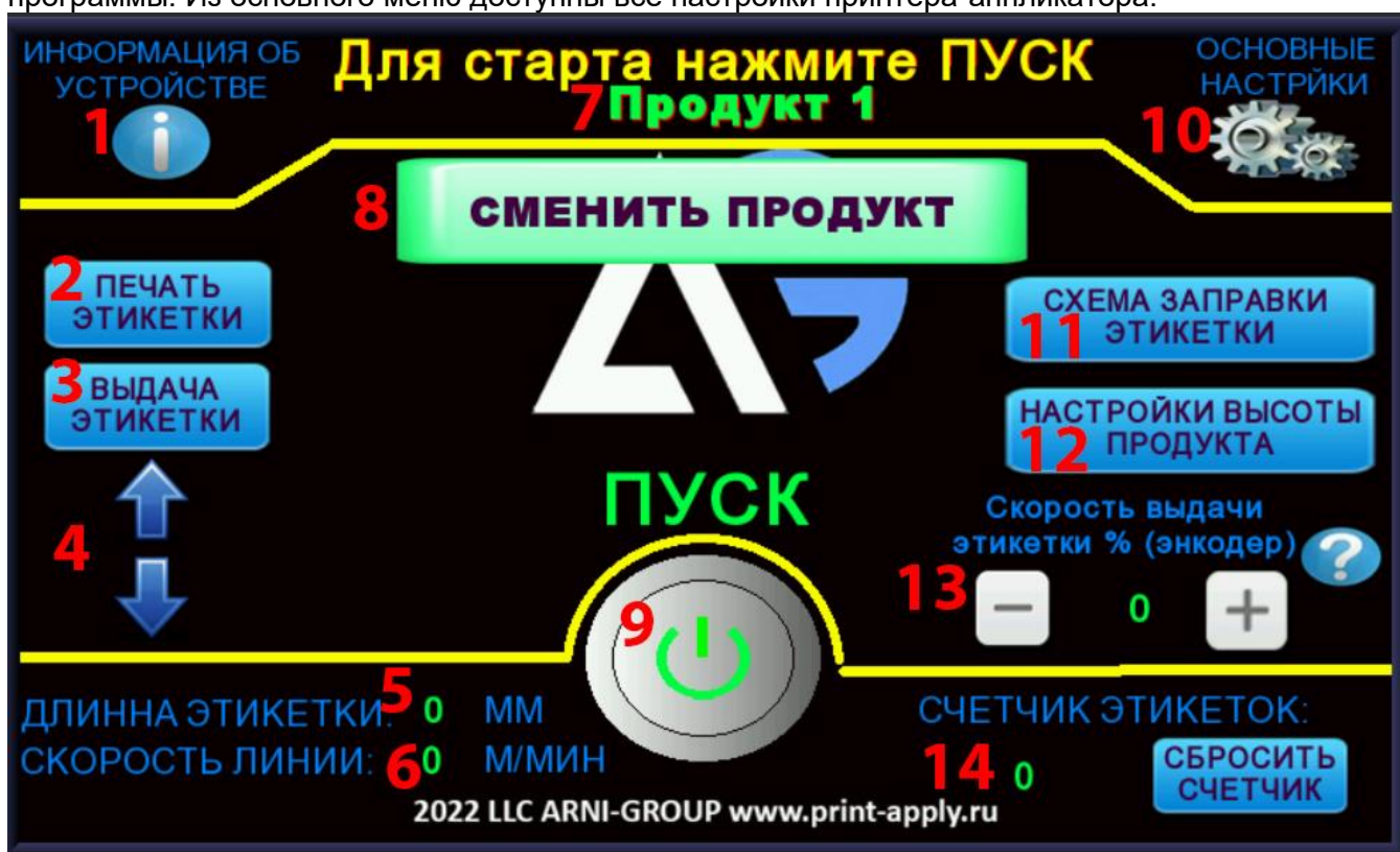
Рисунок 2.10. Основное меню принтера-аппликатора Н-ПР-05.
