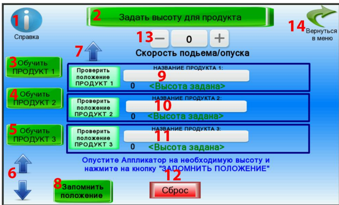
Рисунок 2.12. Меню настроек автоматической регулировки принтера-аппликатора по оси Y.
